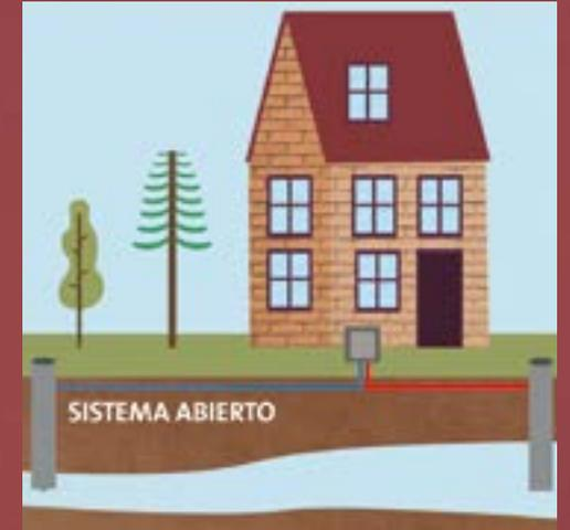
Este es el sistema utilizado por la Escuela Voipir de Ñancul en la comuna de Villarrica. El sistema está compuesto por 2 bombas de calor geotérmicas que permiten aumentar la temperatura extraída del subsuelo, y mantener el interior del edificio entre los 20 y 22°C.
